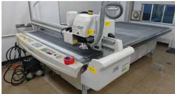
ナップのサイン事業部には2台の働者がいます。1台目はカット能力に長けており、アルミ複合版・アクリル板・段ボール・カルパ・パネルなどの素材を切ることができる「コングスバーク」。カットデータは1mmもずれることがなく、寸法通り正確にカットしてくれます。
